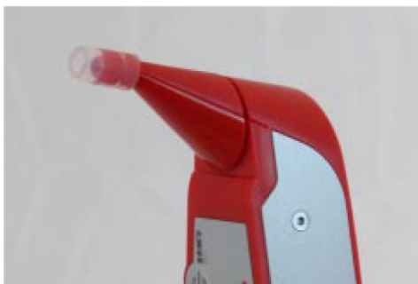
Bild 8: Korrekt placering av silikonslangbiten.
