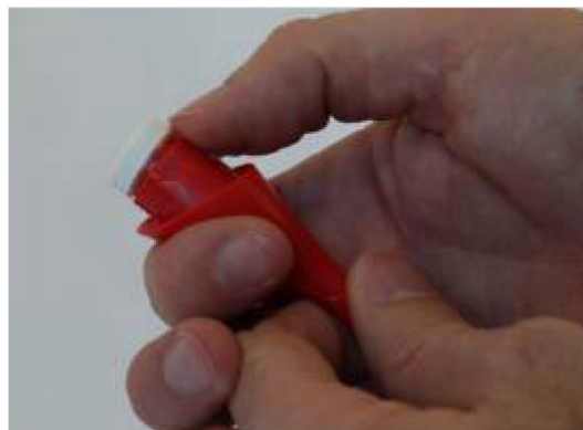
Bild 11: Avlägsnande av membranet
